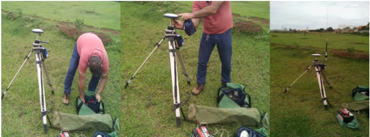
Figura 19. Instalação da base do receptor do GNSS.
