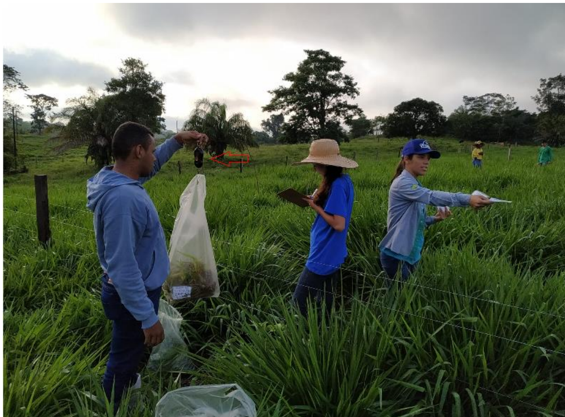
Figura 10 - Pesagem das amostras com balança eletrônica manual
