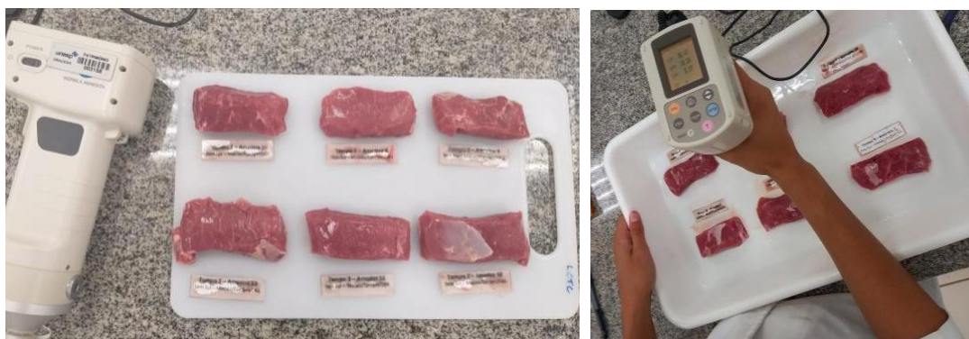
Figura 4 - Avaliações de cor das carnes por meio de espectrofotômetro portátil
