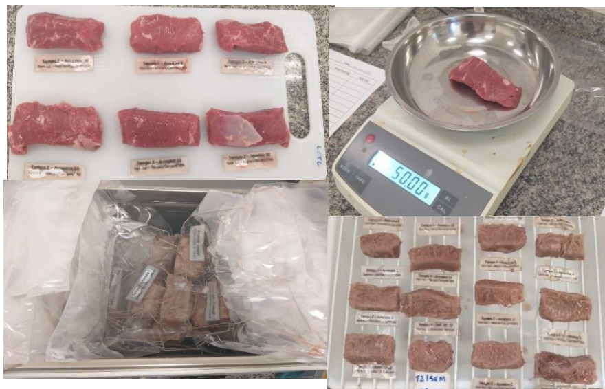
Figura 7 - Pesagem e cocção das amostras para determinação de PPC e maciez
