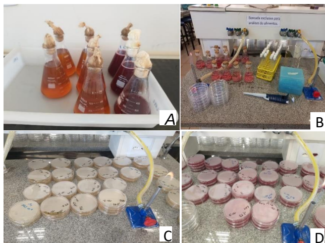
Figura 9 – A) Preparação dos materiais. B) Diluição das amostras. C) Placas de Petri com Àgar Contagem Total de Bactérias. D) Placas com Àgar Cristal Violeta BÍlis Dextrose
