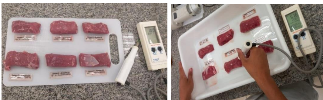
Figura 3 - Avaliação do pH das carnes por meio potenciômetro digital.
