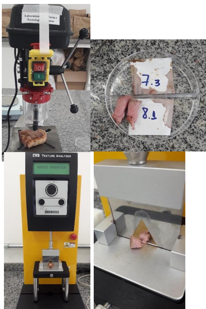
Figura 8 – Determinação da maciez das amostras da carne utilizando texturômetro Brookfield
