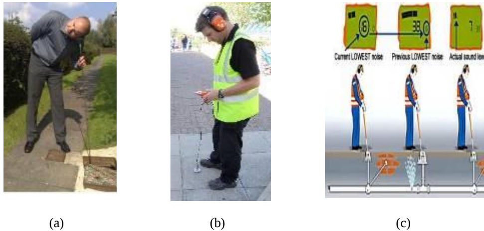
Figura 2 - Técnicas acústicas para detecção e localização de vazamentos: haste de escuta (a), geofone eletrônico (b) e geofone eletrônico com interface elaborada (c).
