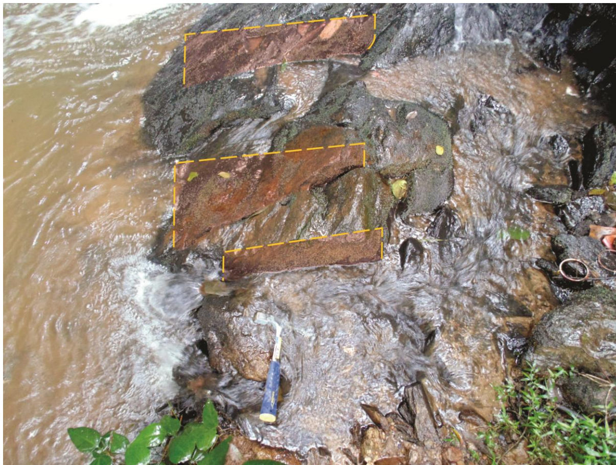
Figura 51: Ilustração dos planos de fraturas de direção NW/SE observados nas rochas do Complexo Embu, ponto 41.
