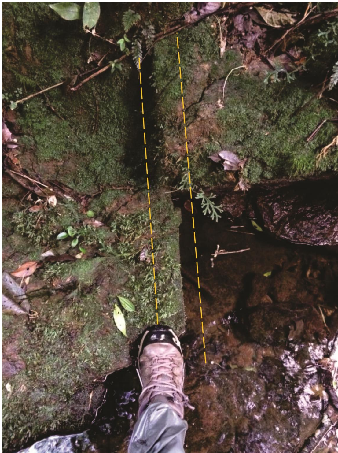
Figura 52: Ilustração evidenciando o plano de fratura de direção NW/SE nos ortognaisses do Complexo Embu, ponto 47.
