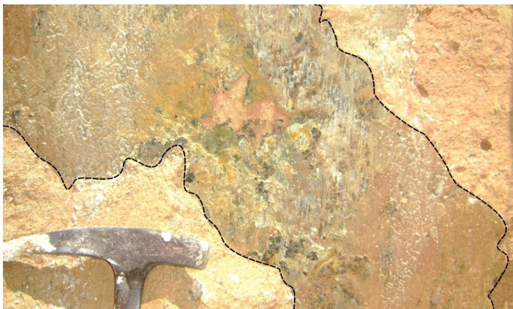
Figura 39: Ponto 14 exibindo um plano de falha bem desenvolvido, com indicação de movimento de subida do bloco norte.
