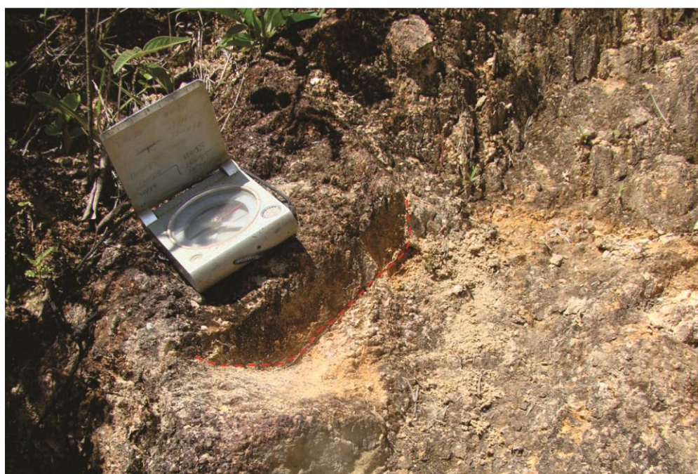
Figura 43: Ponto 26 mostrando um plano de fratura sub vertical de direção NW/SE.
