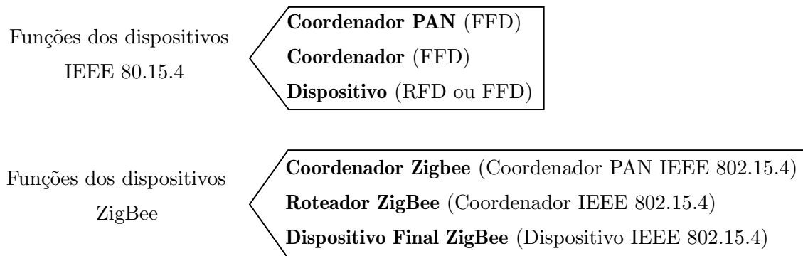
Figura 5 – Relacionamento entre as funções dos dispositivos IEEE 802.15.4 e ZigBee.
