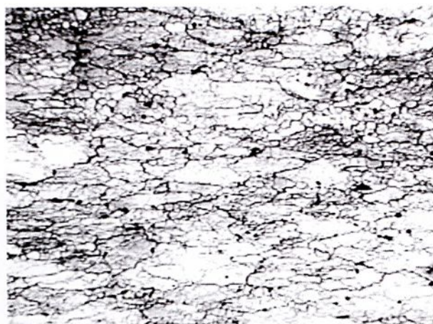
Figura 4.5. Microestrutura da região IV na direção longitudinal da liga Al 7010-T74 ( 400X).
