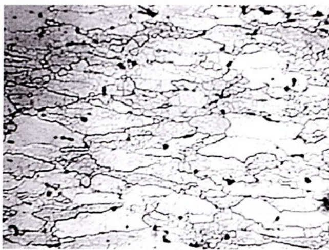
Figura 4.7 Microestrutura na direção transversal da liga Al 7050-T7451 (400X).
