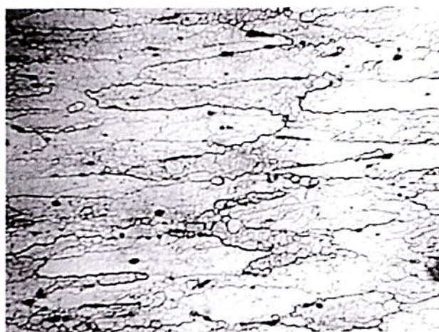
Figura 4.6. Microestrutura na direção longitudinal da liga Al 7050-T7451 (400X).
