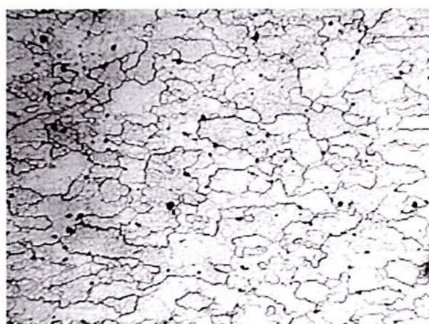
Figura 4.4. Microestrutura da região I na direção transversal da liga Al 7010-T74 (400X).
