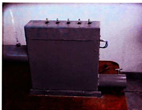
Figura 17 - Foto da fonte de aquecimento de ar com 5 resistores, ligados individualmente
