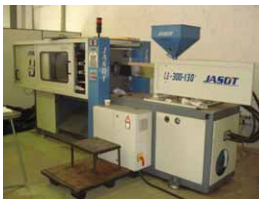
Figura 8 - Máquina Injetora de Plásticos
