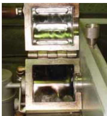
Figura 5– Detalhe da capsula bi partida do misturador termocinético
