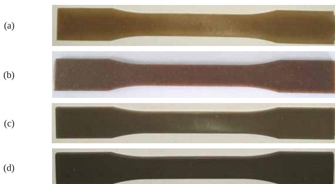
Figura 15- Corpos de prova de tração reforçados com fibras de abacaxi 5% (a) e 10% (b) e híbridos (fibras de abacaxi/ fibras de vidro) 5% (c) e 10% (d), em massa, sem escala
