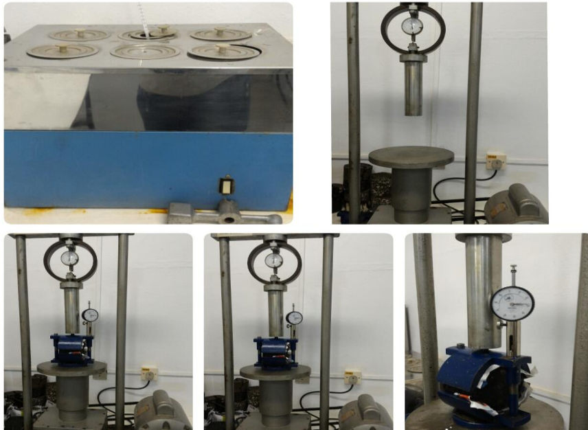
Figura 19. Corpo de prova em banho-maria a 60°C e ensaio de estabilidade e fluência.
