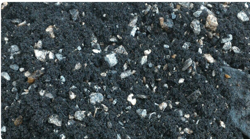
Figura 26. Mistura dos agregados com ligante e com borracha.
