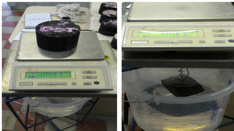
Figura 18. Pesagem dos corpos de prova na balança e imersos.
