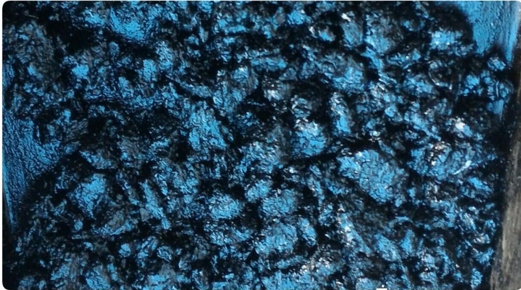
Figura 27. Mistura dos agregados com ligante sem borracha.
