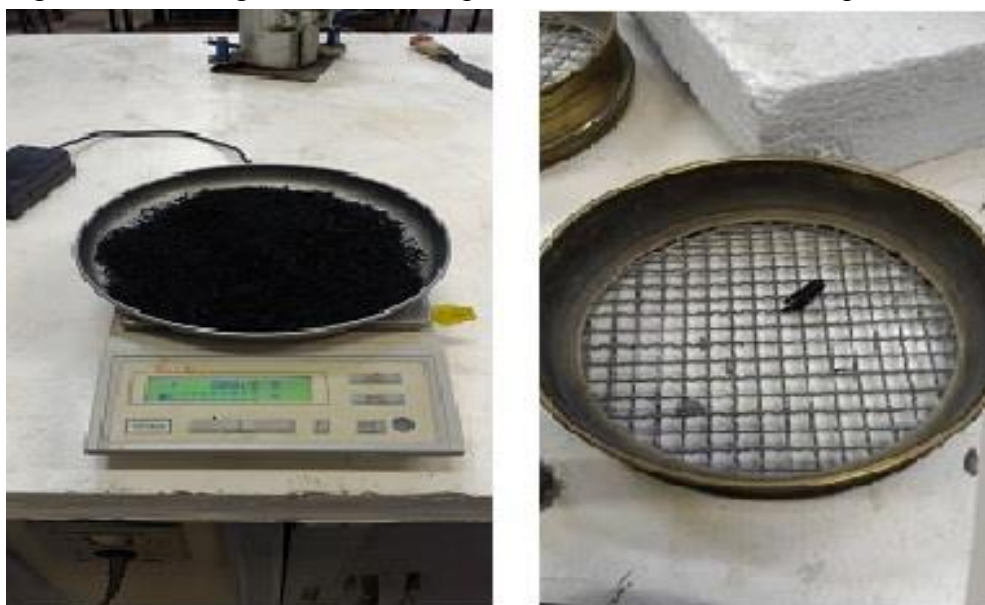
Figura 6 e 7. Pesagem, da borracha para ensaio e massa retida na peneira 3/8".
