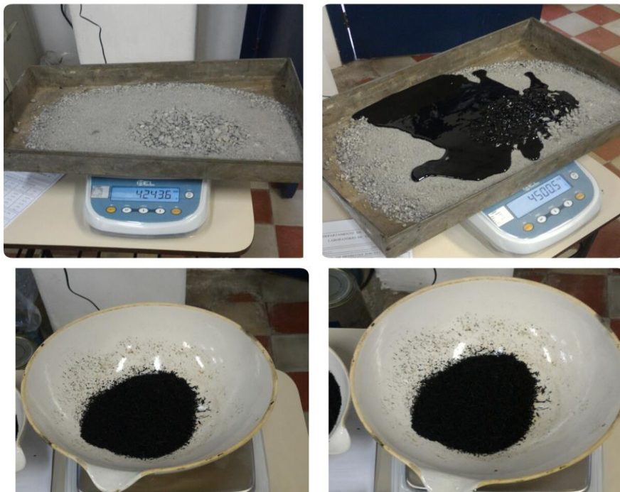
Figura 14. Pesagem e preparação do material para mistura.
