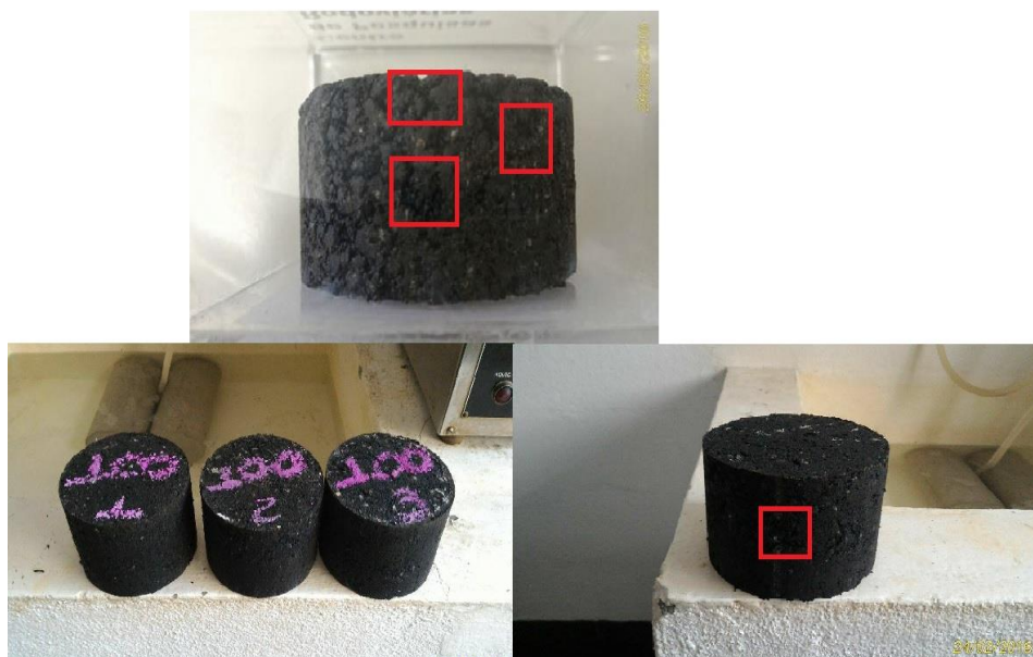
Figura 22. Diferença de vazios nos corpos de prova faixa A.
