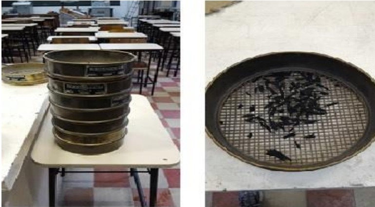
Figura 8 e 9. Conjunto de peneiras e massa retida na peneira 4.
