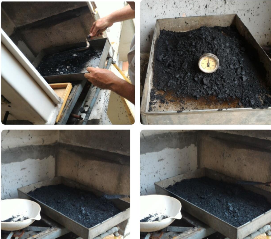
Figura 15. Preparação da mistura à 135°C.
