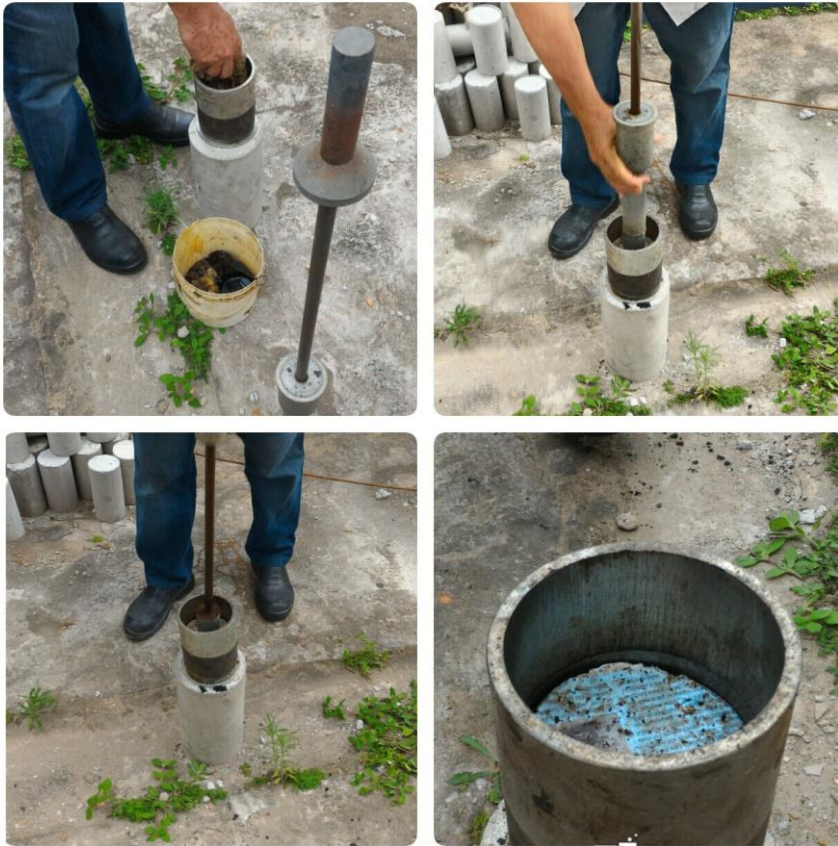
Figura 25. Moldagem e compactação dos corpos de prova.
