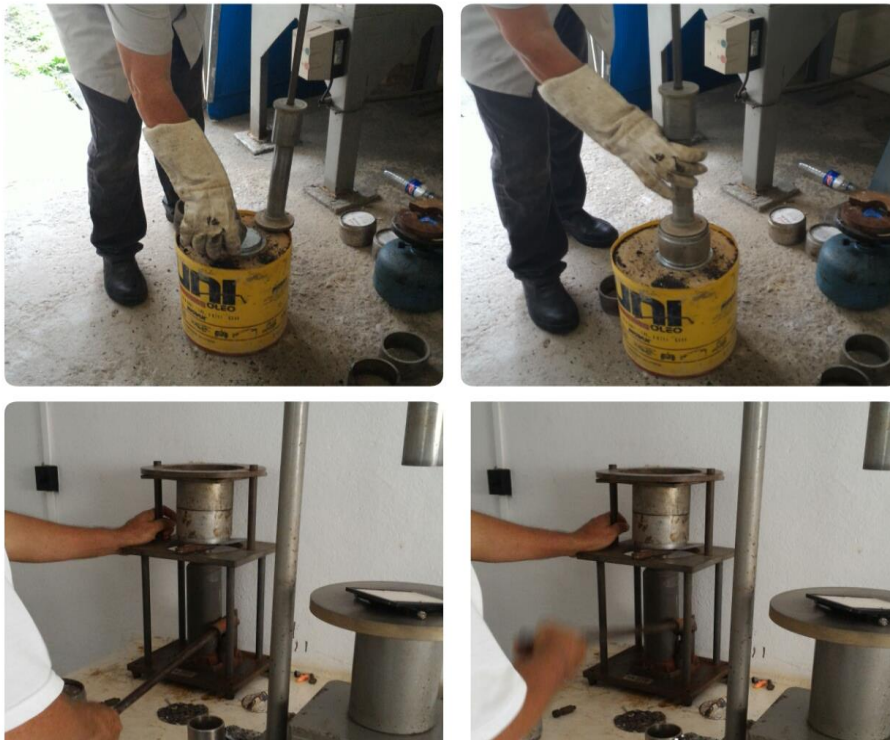
Figura 16. Moldagem e extração dos corpos de prova.
