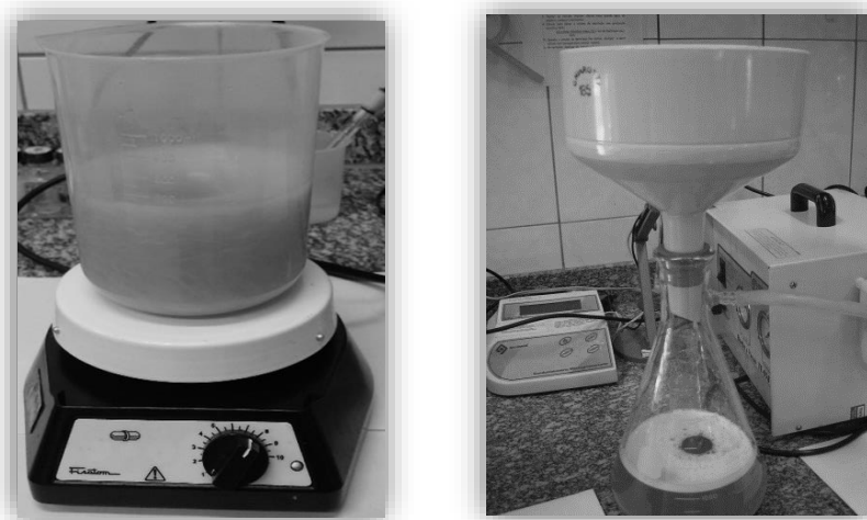
Figura 16: Extrato de semente de moringa com diluição em \text{CaCl}_2 em agitação por 10 minutos e posterior filtração a vácuo. Fonte: Acervo Pessoal.
