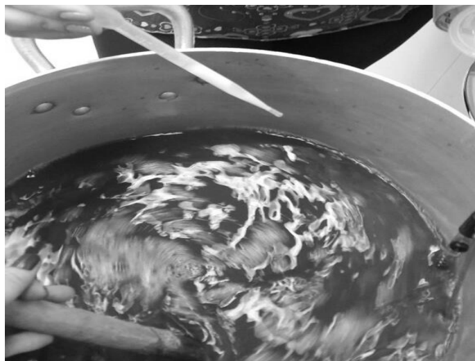
Figura 18: Ajuste do pH, com adição de leite de cal – pH 6,0 (produção de etanol) e pH 7,0 -8,0 (produção de açúcar). Fonte: Acervo Pessoal.
