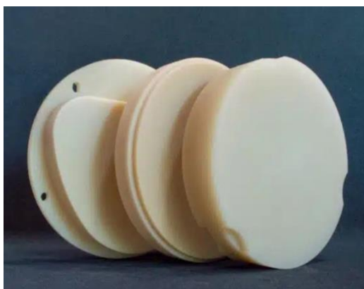
Figura 12- Blocos InCeram Alumina, InCeram Zircônia e InCeram Spinell
