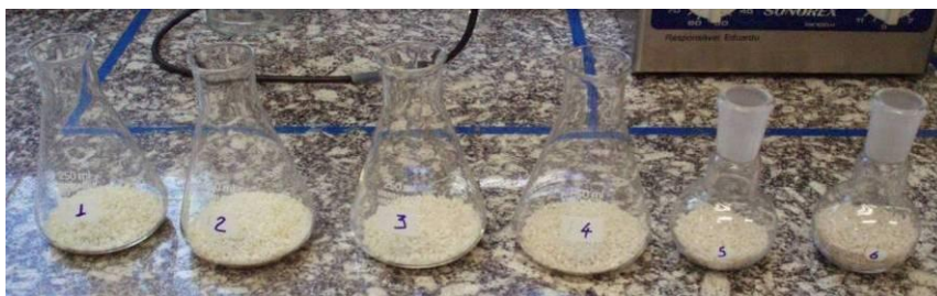
Figura 4.4 – Amostras de PA6,6-GF25 separadas por ciclos de moagem, sendo 1 relativo ao material colhido após a primeira moagem, 2 a segunda e assim consequentemente até a sexta moagem representada pelo balão volumétrico 6.
