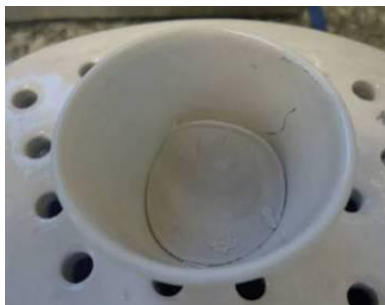
Figura 4.10 – Cadinho cerâmico reutilizável após calcinação resfriando em dessecador.
