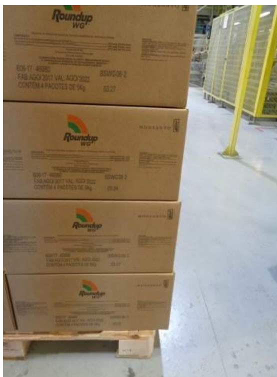
Figura 45 – Caixas ultrapassam limites do paleta.
