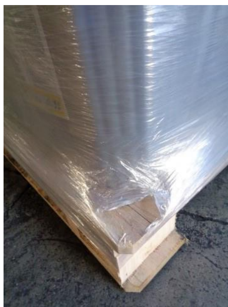
Figura 18 – Grande rasgo na quina.
