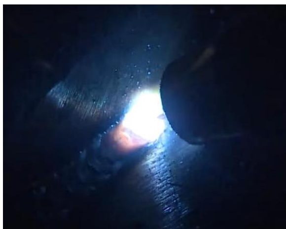
Figura 4.25 - Fluxo de energia na soldagem GMAW-MAG
