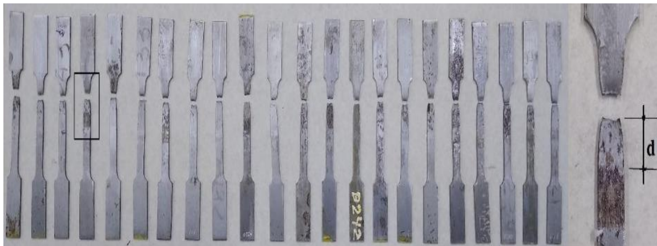
Figura 6.1 - Rompimento dos corpos de prova ao teste de tração do grupo A
