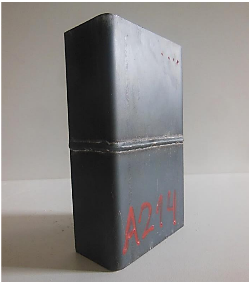
Figura 5.1 - Procedimento de soldagem elaborado no conjunto de Peças de teste A2
