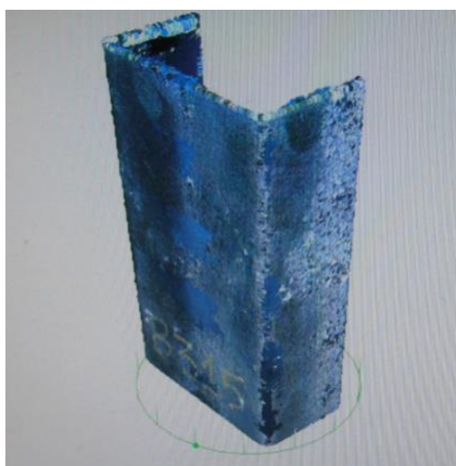
Figura 4.8 - Captura tridimensional da nuvem de pontos do escaneamento a laser
