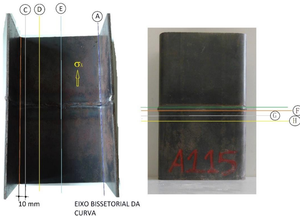
Figura 5.16 - Representação dos planos de corte na Peça de teste
