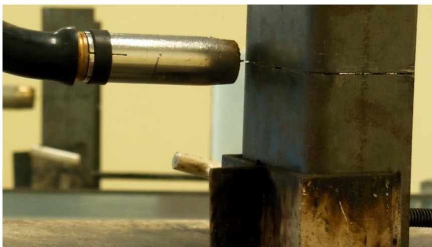
Figura 4.3 - Preparo da Peça de teste para o procedimento de soldagem na posição 2G
