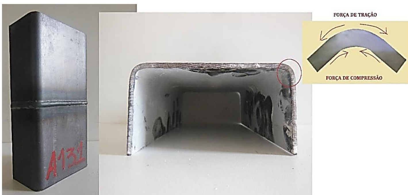
Figura 4.12 - Deformação por dobramento
