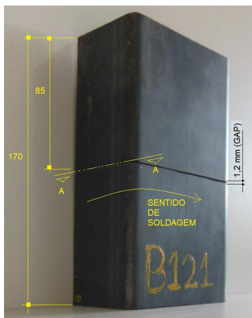
Figura 4.2 - Preparação e posicionamento-padrão das juntas
