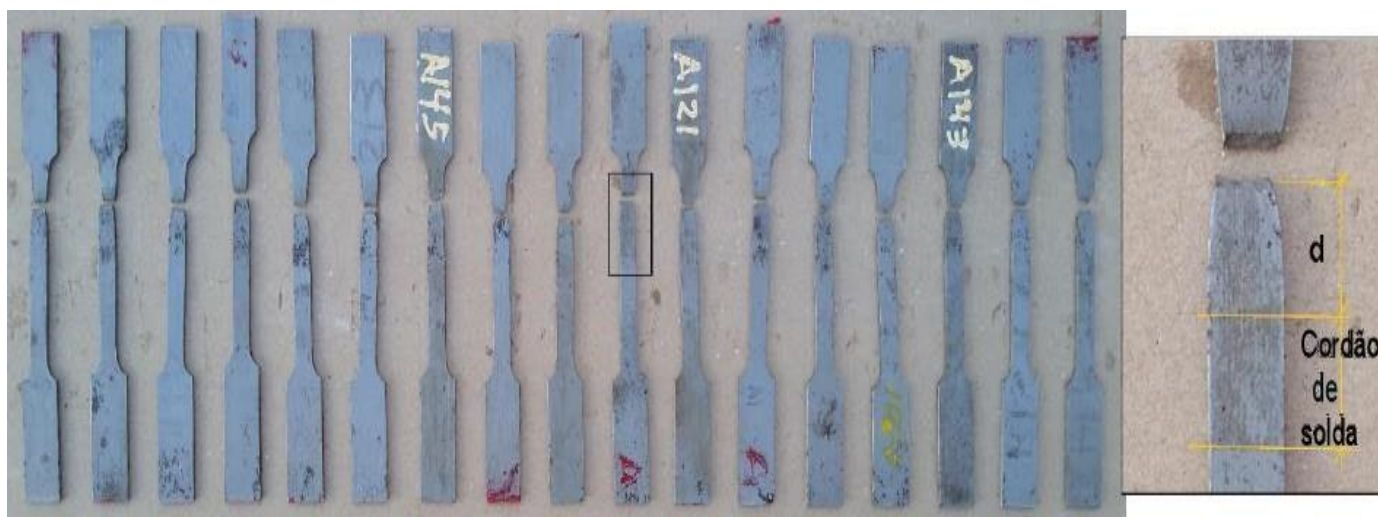
Figura 6.2 - Rompimento dos corpos de prova ao teste de tração do grupo B
