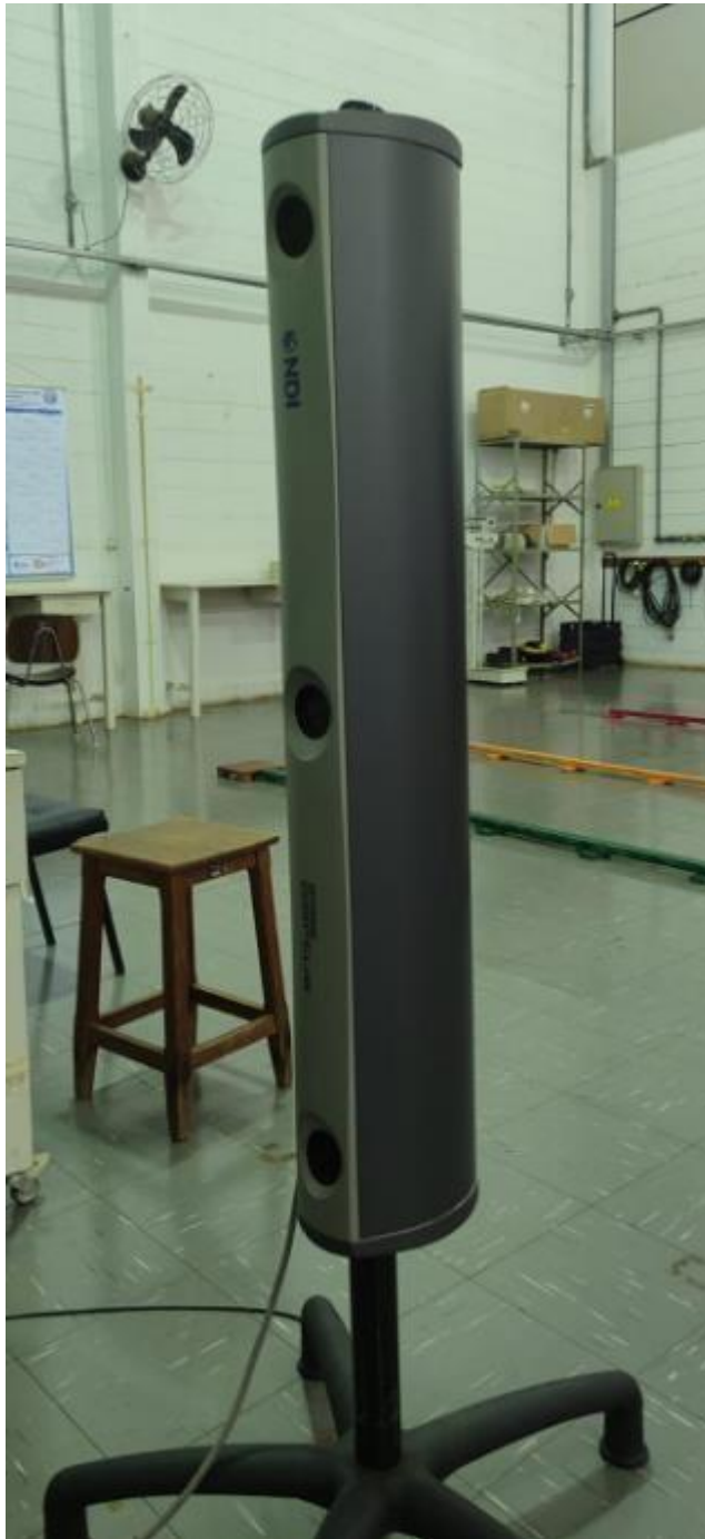
Figura 3 - Optotrak utilizado para monitorar a oscilação de cada participante durante o experimento.
