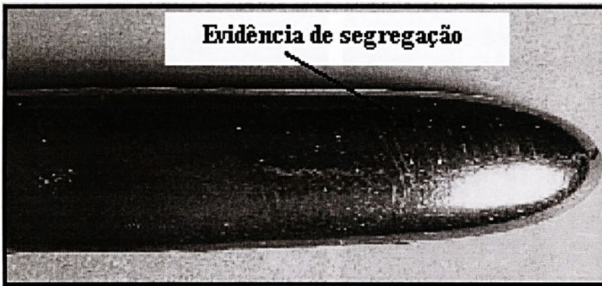
Figura 4.1 – Macroestrutura representativa dos lingotes de chumbo mostrando a formação de campo de segregação (posição de 95%).
