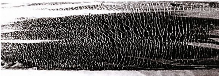
Figura 4.2 – Macrografia de um lingote de chumbo purificado mostrando maclas devido à manipulação laboratorial. Aumento 20X.
