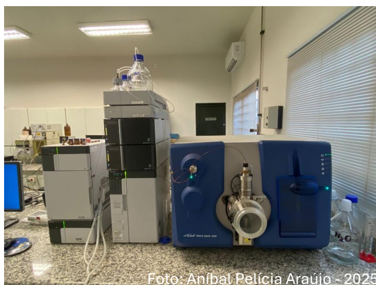
Figura 8 - Cromatógrafo Líquido de Alta Eficiência (Prominence UFLC) - HPLC e espectrômetro de massas triplo quadrupolo (LC-MS/MS) utilizado no desenvolvimento do método analítico de determinação do diclosulam + halauxifen-methyl
