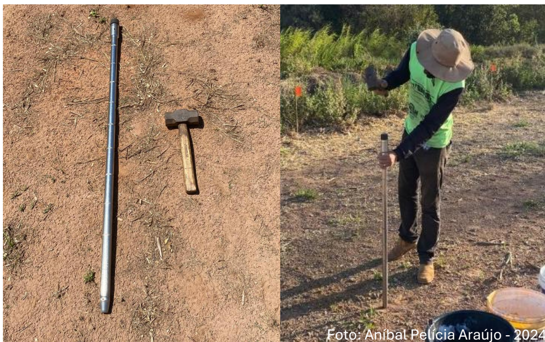
Figura 6 - Trado utilizado e procedimento de amostragem de solo para análise do residual dos ingredientes ativos testados
