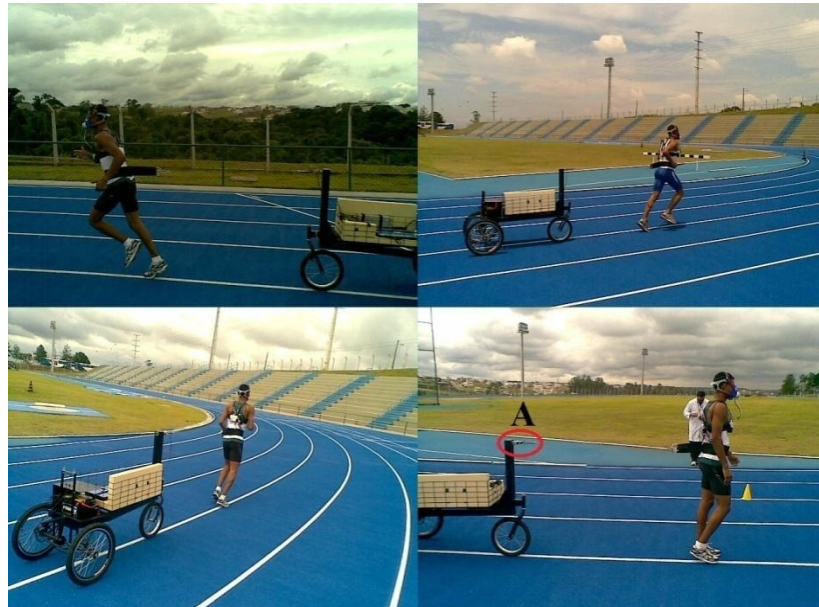
Figura 5 - Voluntário atado ao aparato móvel para a realização dos testes de corrida resistida em pista. A) Fixação do cabo de aço à célula de carga ajustada à altura da cintura do indivíduo.
