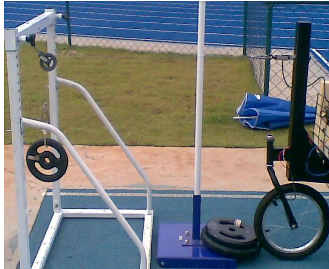
Figura 6 - Sistema utilizado para ajuste da resistência individual imposta nos testes de corrida resistida e calibrações para aferição da força a partir dos sinais da célula de carga.
