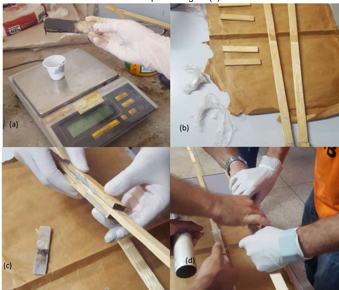
Figura 38 – Processo de pesagem (a), separação (b), aplicação (c) e proteção da talisca para colagem (d)
