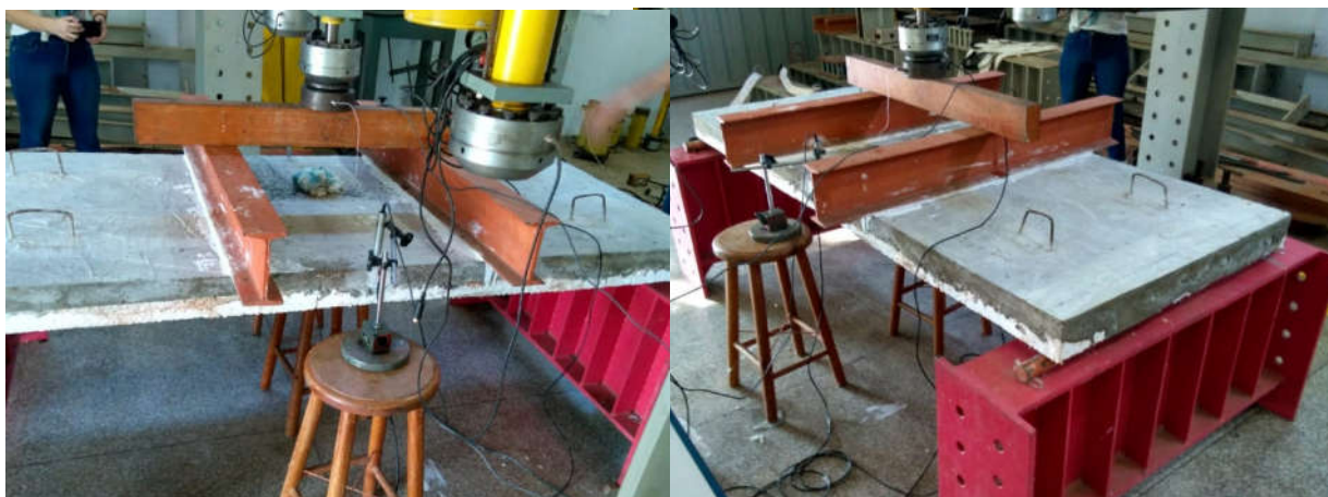
Figura 55 – Ensaio de flexão da laje
