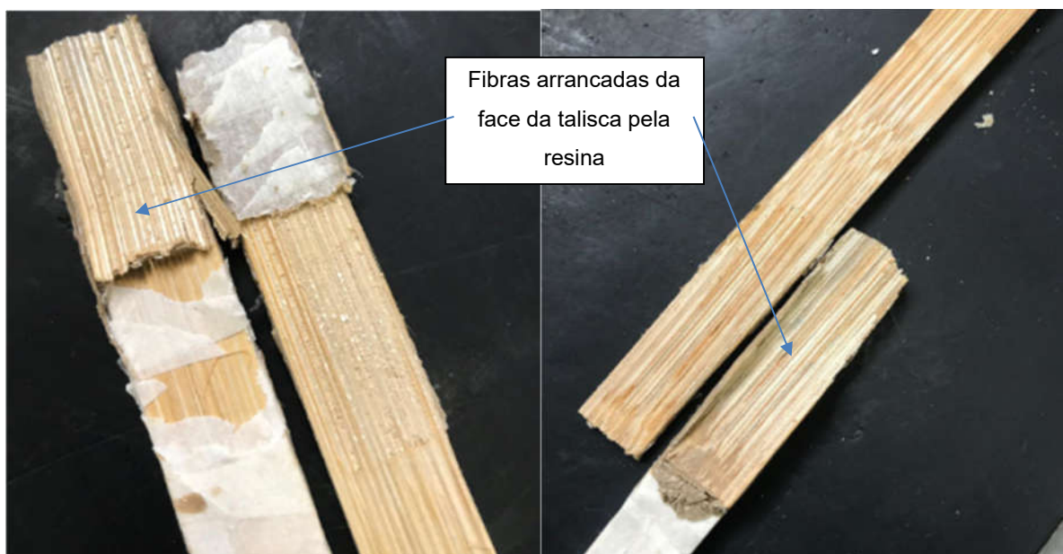
Figura 73 – Corpos de prova do ensaio de cisalhamento rompidos
