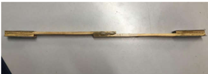
Figura 56 – Corpo de prova de cisalhamento no plano de colagem
