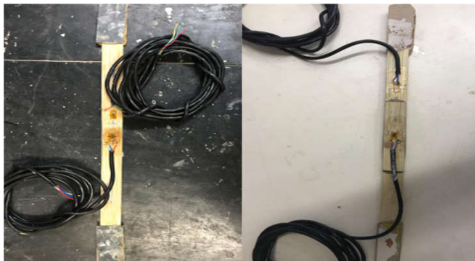
Figura 57 – Corpos de prova dos ensaios de determinação do módulo de elasticidade do bambu
