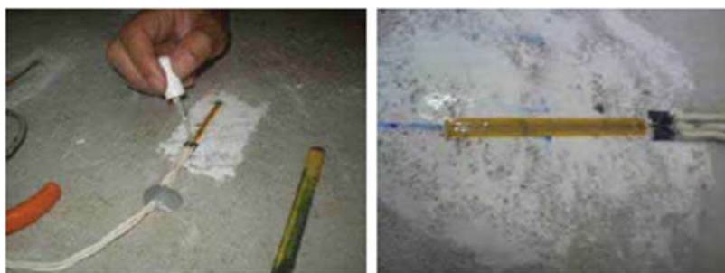
Figura 53 – Extensômetros colados na capa de concreto do protótipo
