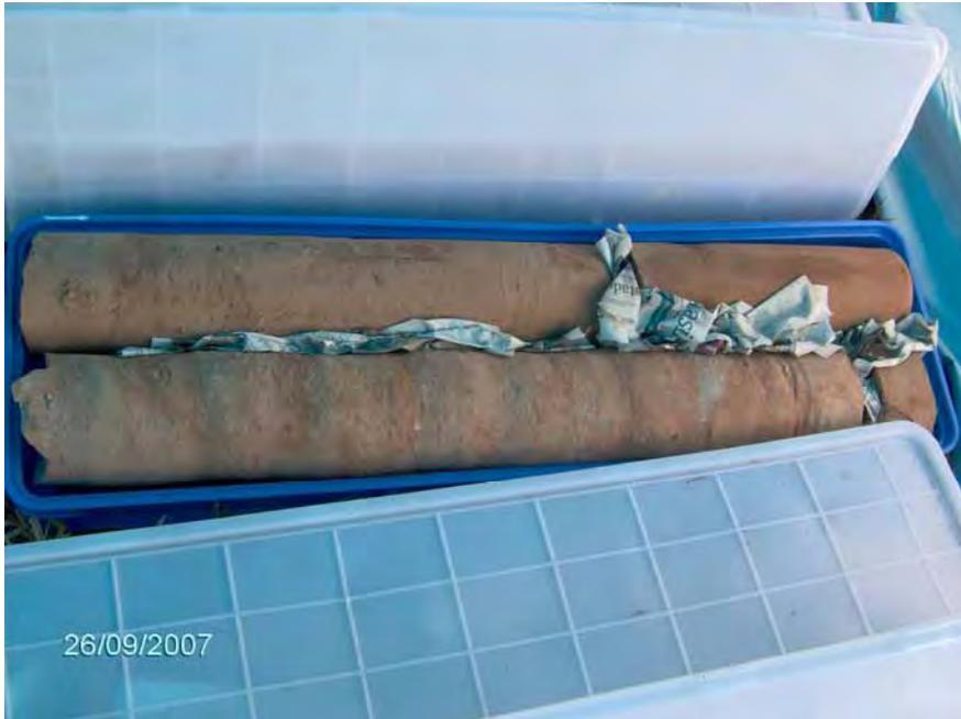
**Figura 5– Amostras indeformadas dos poços estratigráficos (Piacatu)**
