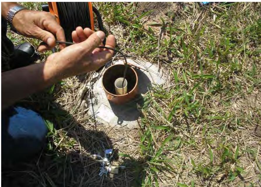
**Figura 7 – Poço piezométrico na Bacia do Arrependido**
