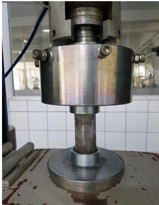
Figura 12 - Corpo de prova capeado com Neoprene centralizado na prensa hidráulica.
