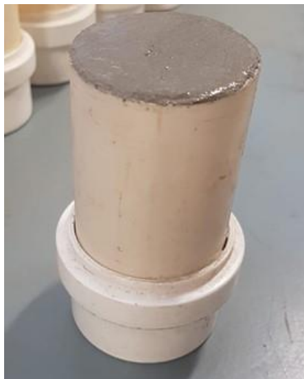
Figura 6 - Corpo de prova preenchido com argamassa.
