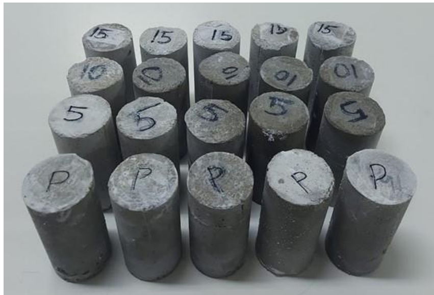
Figura 8 - Corpos de prova desmoldados.
