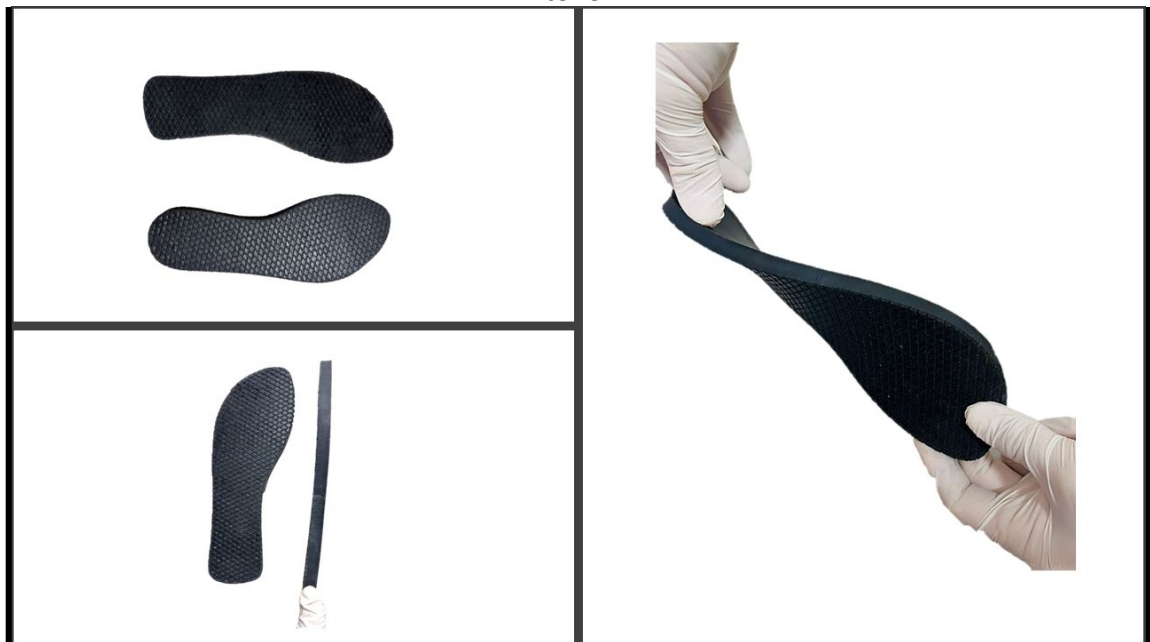
Figura 32 - Confeção de um protótipo de solado de calçado contendo 40 phr de resíduo de toner
