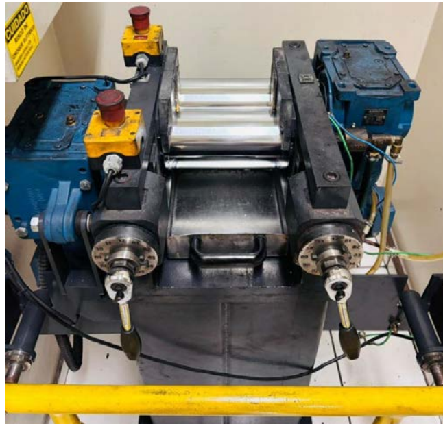
Figura 11 - Misturador aberto de rolos da marca Veiga Sul
