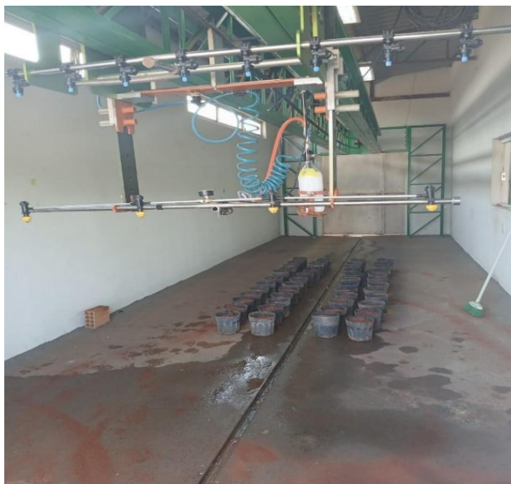
Figura 3. Pulverização do herbicida indaziflam por meio de aplicação laboratorial automatizada.
