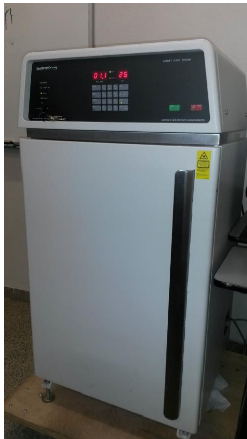
Figura 2 - Equipamento de Raio-X (FFCLRP-USP) utilizado para radiografar os espécimes dos complexos de Astyanax fasciatus e A. scabripinnis do presente trabalho.
