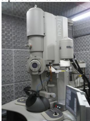
Figura 23 TECnai, equipamento de microscopia eletrônica de transmissão
