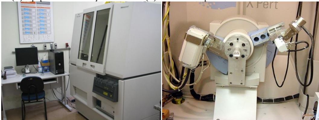
Figura 25 (A) Equipamento de difração de raios-X. (B) emissor e receptor dos raios-X
