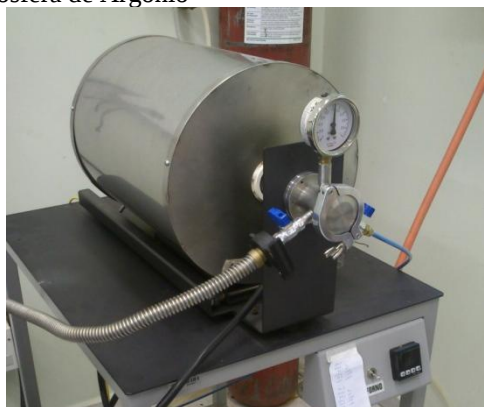
Figura 12 Forno tubular com atmosfera de Argônio
