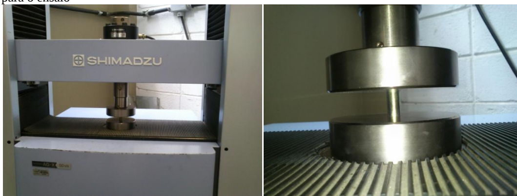
Figura 30 (A) Equipamento de ensaios mecânico Shimadzu, (B) Matriz aberta com corpo de Prova posicionado para o ensaio
