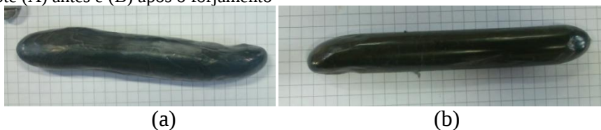
Figura 15 Lingote (A) antes e (B) após o forjamento
