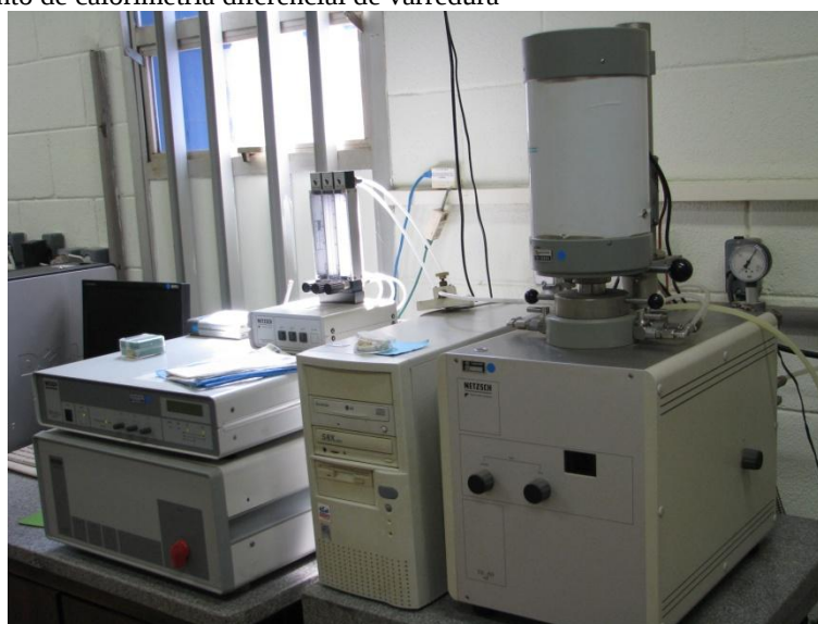
Figura 24 Equipamento de calorimetria diferencial de varredura
