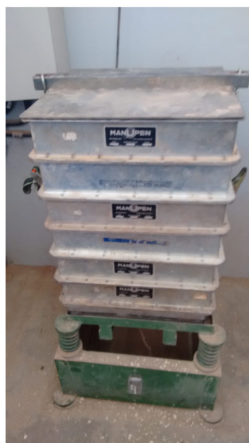
Figura 9 – Agitador de Peneiras utilizados para separação dimensional das maravalhas
