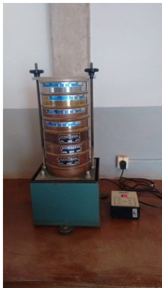
Figura 10 – Determinação da composição granulométrica das maravalhas de madeira
