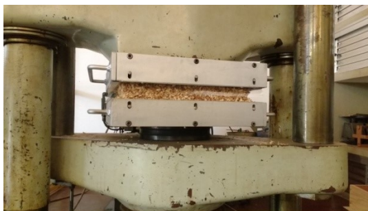
Figura 15 – Prensa utilizada na prensagem dos Painéis
