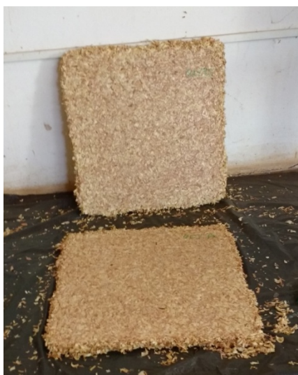
Figura 16 – Aspectos gerais dos painéis após prensagem
