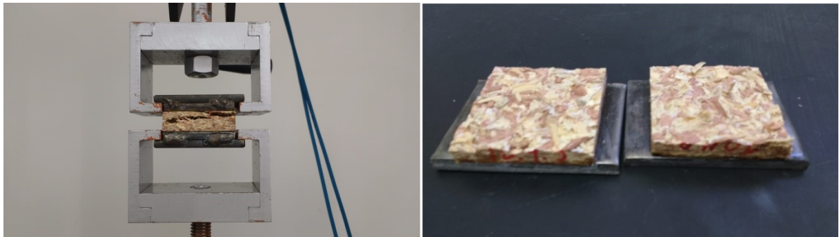
Figura 20 – Aspectos Gerais do Ensaio de Resistência à Tração Perpendicular no Momento da Ruptura de um cp.
