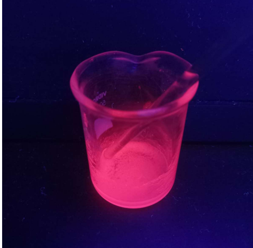
Figura 11: Tinta luminescente após a solubilizar a Eu-mof em limoneno.
