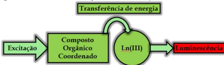
Figura 7: Efeito antena em compostos de coordenação com íons lantanídeos.
