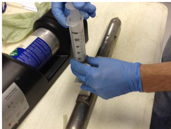
Foto 10: Injeção das misturas gasosas na sonda MIP.
