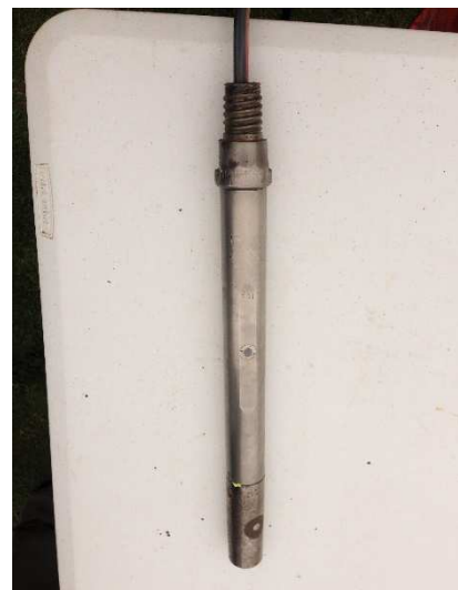
Foto 18: Ponteira utilizada nos ensaios com o sistema SCOST.
