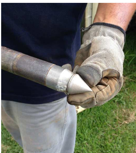
Foto 19: Dispositivo PRT para amostragem de gases, fechado com a ponteira de cravação.
