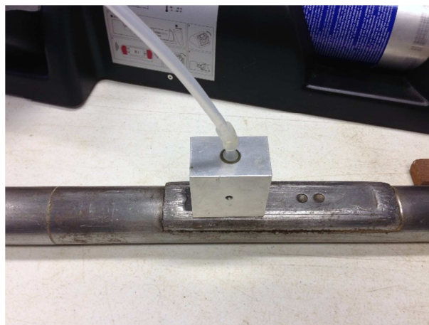
Foto 8: Execução dos testes de resposta. Destaque para o dispositivo de injeção de gás na sonda MIP.
