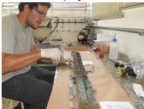
Foto 24: Descrição tátil visual e coleta de amostras de solo para caracterização geotécnica.
