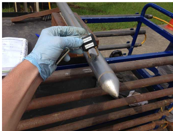
Foto 16: Teste de resposta do sensor de condutividade elétrica.
