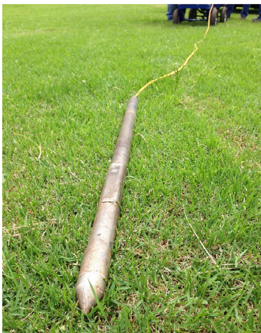
Foto 13: Sonda MIP utilizada nos ensaios de campo.
