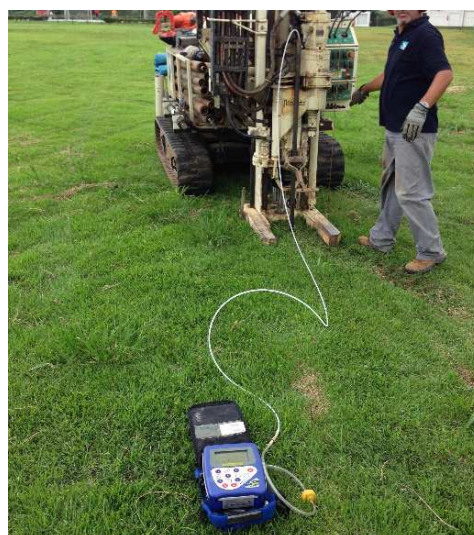
Foto 20: Ensaio de amostragem de gases do solo pelo sistema PRT.
