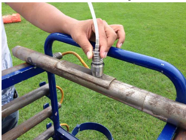
Foto 15: Teste de resposta do detector FID à amostra de biogás.
