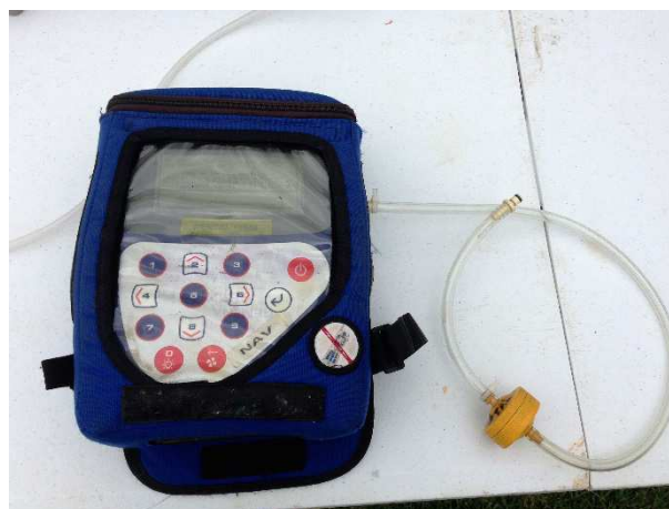
Foto 12: Equipamento portátil para medição de biogás, modelo GEM-2000.
