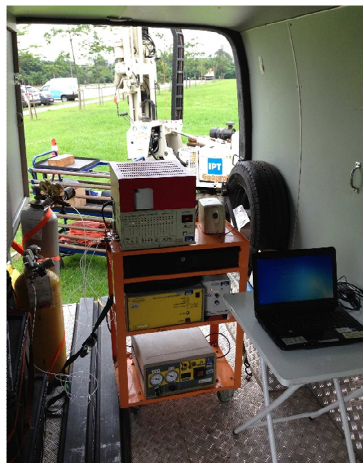
Foto 14: Sistema MIP montado no interior do veículo VAN.
