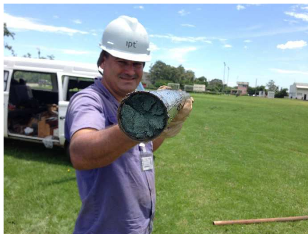
Foto 22: Amostrador liner com presença de sedimentos paleogênicos da BSP.
