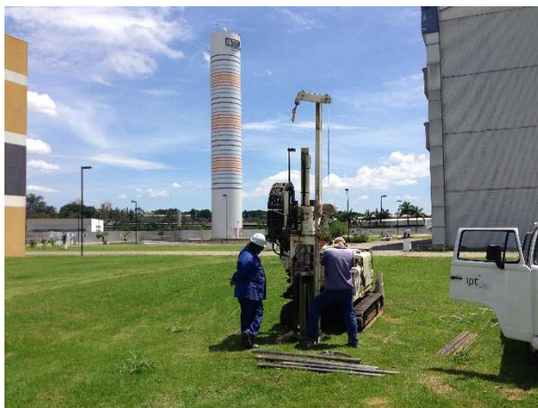
Foto 21: Execução de amostragem de solo pelo método Direct Push .
