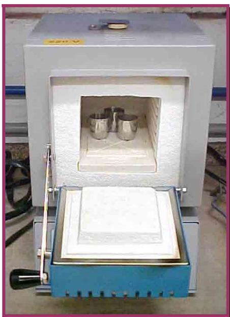
Figura 13: Cadinhos de platina em forno tipo mufla utilizados na gravimetria.
