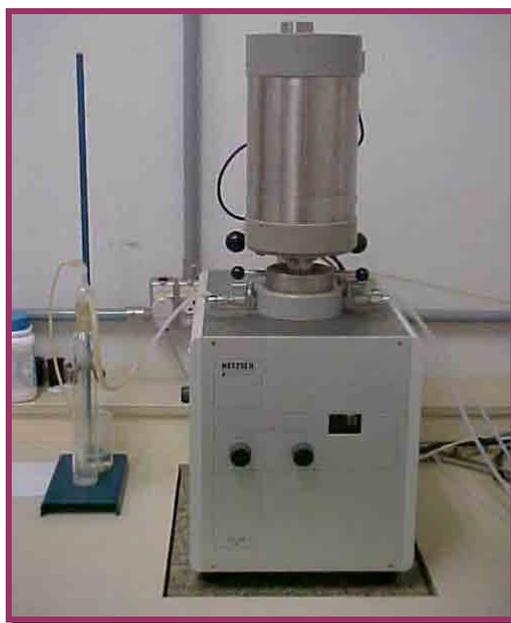
Figura 14: Equipamento de análise TG/DTA simultânea utilizado para caracterização dos poliésteres, resinas carbonizadas e os intermediários MN-PbC<sub>2</sub>O<sub>4</sub> e MN-PbO.
