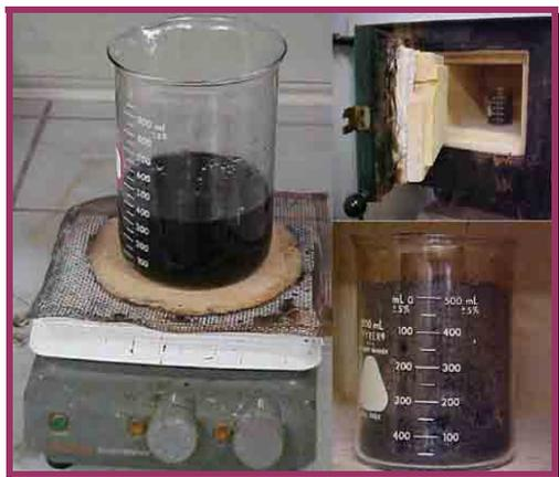
Figura 7: Etapas de obtenção do precursor carbonizado a partir do citrato dos metais.
