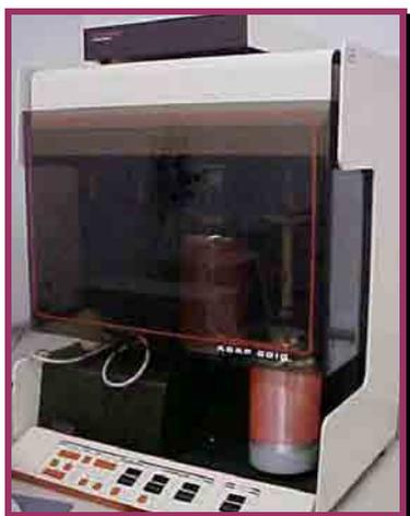
Figura 16: Equipamento utilizado nas medidas de área superficial dos pós de MN e de PMN.
