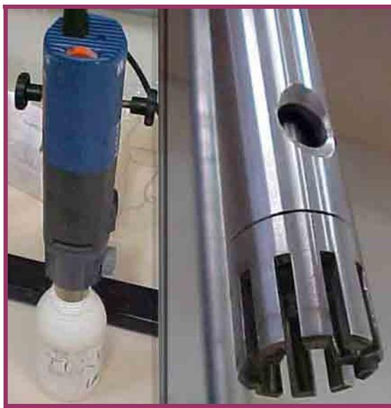
Figura 10: Turbina utilizada na homogeneização dos coprecipitados MN-PbC<sub>2</sub>O<sub>4</sub>.
