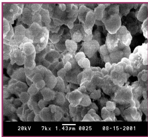
Figura 53: Micrografia eletrônica de varredura da fratura da amostra compactada depois da eliminação do aglomerante, obtida pelo processamento P4.
