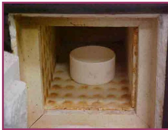
Figura 8: Calcinação de pós cerâmicos em cadinho de alumina e forno tipo mufla.
