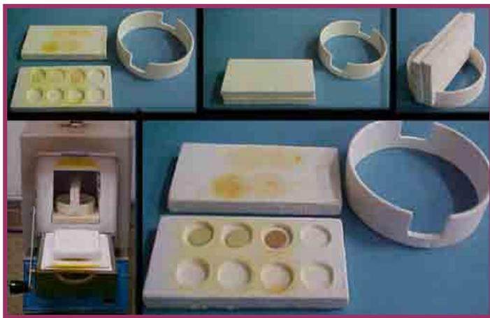
Figura 12: Seqüência do processo de sinterização das pastilhas cerâmicas utilizando aparato de sinterização construído em nossos laboratórios.
