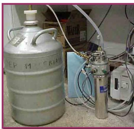
Figura 19: Tipo de criostato utilizado nas medidas elétricas a baixas temperaturas das amostras de PMN.
