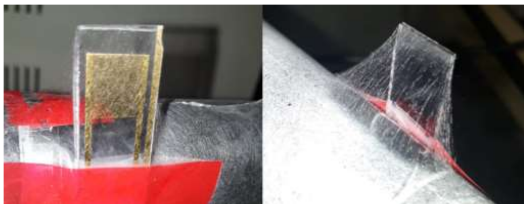
Figura 22: Nanofibras eletrofiadas sobre o IDE.
