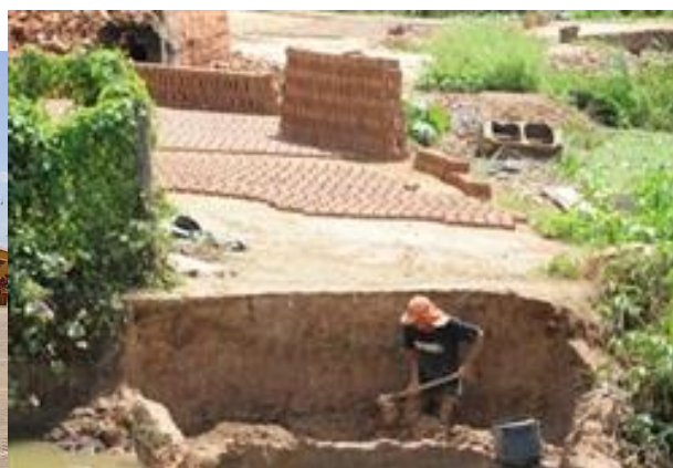
Figura 63: Extração de argila realizada de modo manual, no bairro Olarias, zona norte de Teresina.
