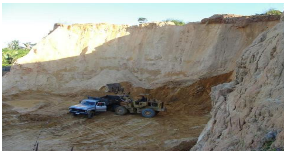
Figura 60: Intensa atividade de extração de massará em área de inclinação acentuada, no bairro Bela Vista, zona sul de Teresina.
