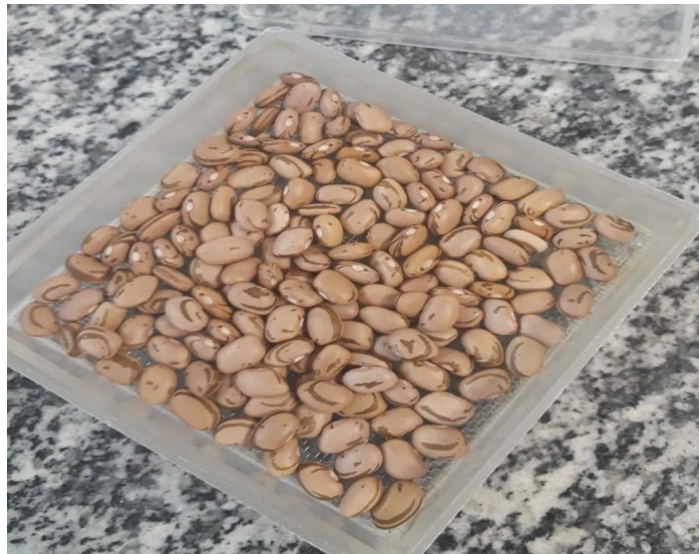
Figura 6. Caixa Gerbox com sementes de feijão que irão para a BOD por 72 horas a 41°C, passar pelo processo de envelhecimento. Ilha Solteira – SP, Brasil, 2021.
