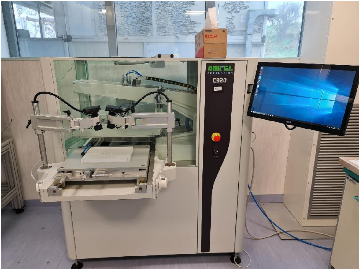
Figura 20 – Equipamento semi-automático utilizado para a deposição dos filmes espessos pela técnica de screen-printing
