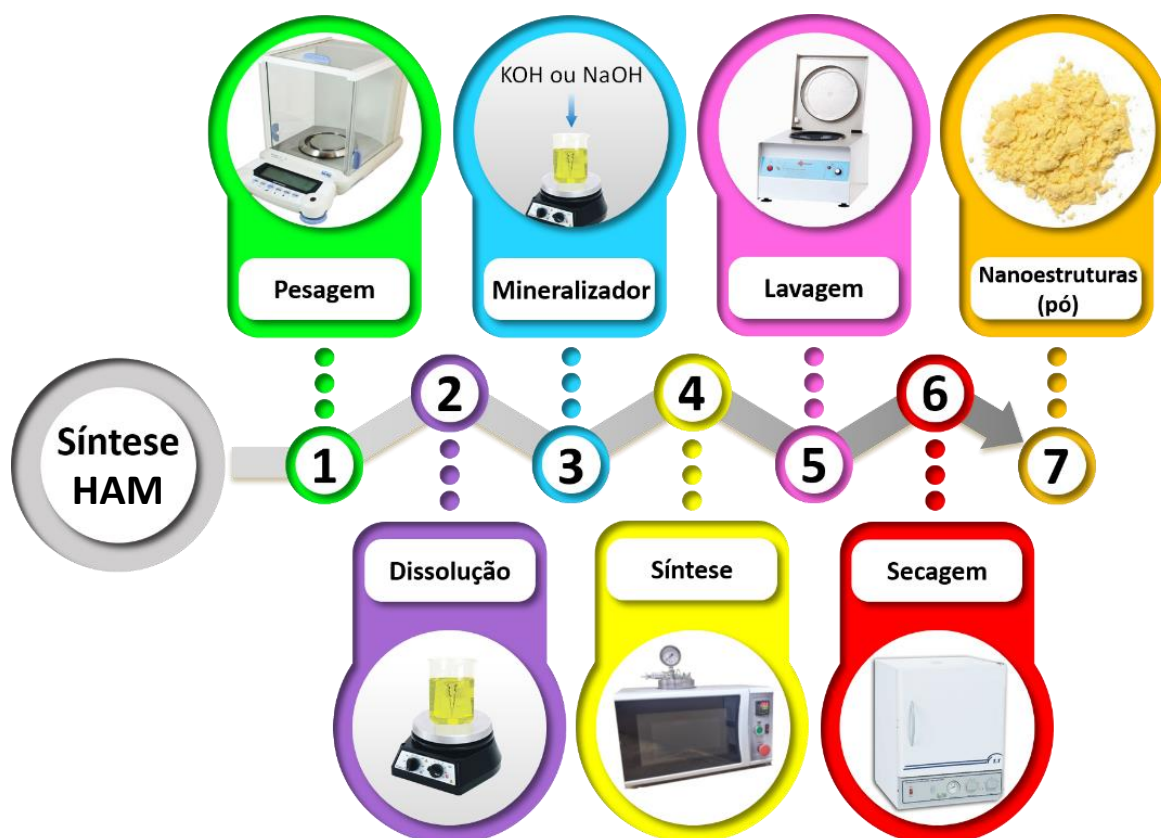
Figura 9 – Etapas da síntese hidrotermal assistida por micro-ondas (HAM)
