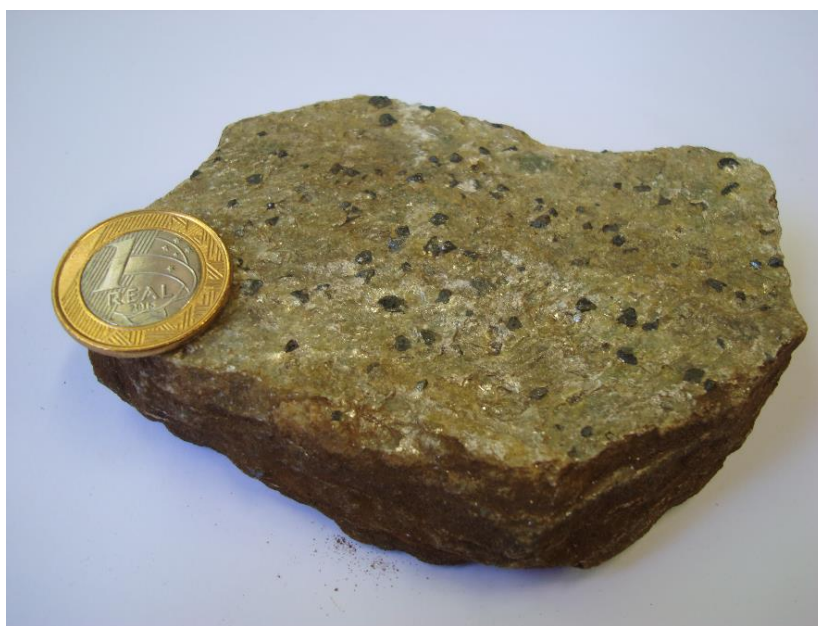
Figura 24. Amostra de filito/xisto fino amarelo-prateado com diversos porfiroblastos de magnetita.
