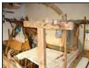
foto 13 – trava, braço e varão do tear
