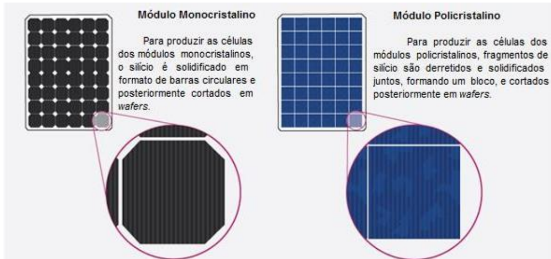
Figura 9 - Comparação entre células de p-Si e m-Si e sua disposição em módulos fotovoltaicos.
