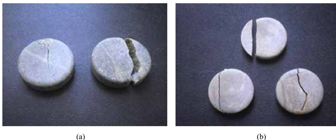
Figura 39 – (a) Corpos-de-prova da rocha verde e, (b) da rocha creme após o ensaio de compressão diametral.
