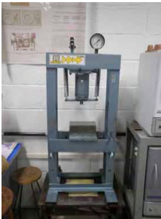
Figura 18 – Prensa hidráulica do laboratório de cerâmica do Departamento de Materiais e Tecnologia da UNESP, campus de Guaratinguetá, utilizada no processamento das amostras desse trabalho.
