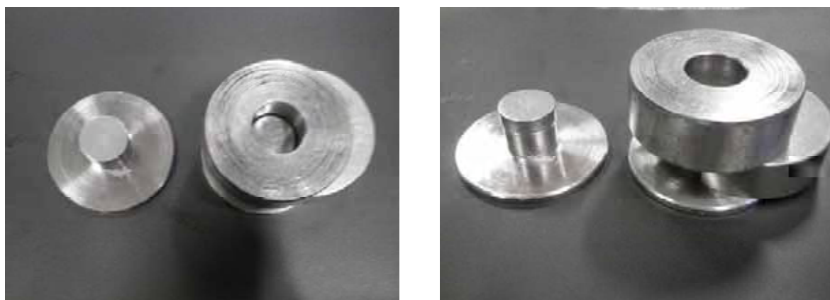
Figura 21 – Molde de aço para confeccionar corpos-de-prova em discos com 20 mm de diâmetro.
