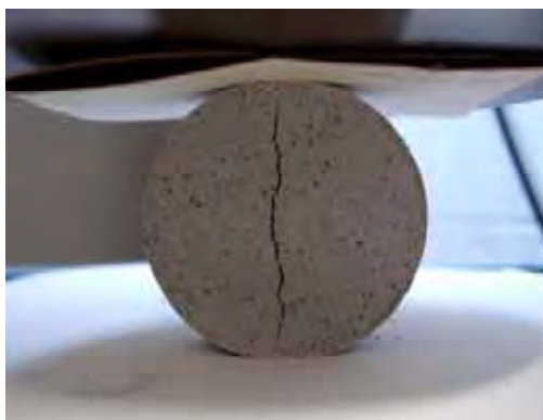
Figura 38 – Pedra sintética, contendo o resíduo R3, no momento da ruptura por compressão diametral.
