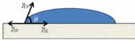
Figura 4.3 Esquema ilustrativo da representação de forças de origem Coulombiana quando uma gota de água depositada sobre uma superfície.
