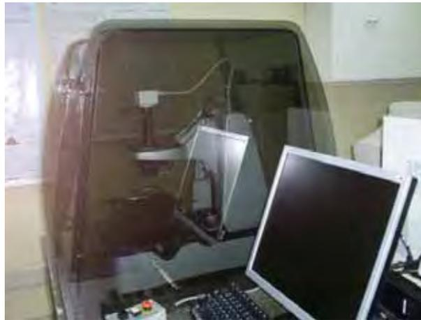
Figura 4.4 Fotografia do perfilômetro utilizado neste trabalho.
