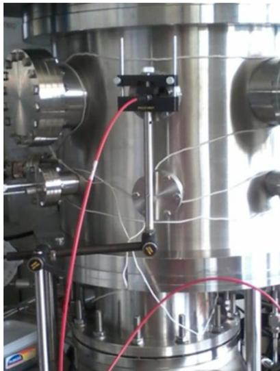
**Figura 12:** Fixação da fibra óptica na câmara de deposição para realizar os experimentos de emissão do plasma.
