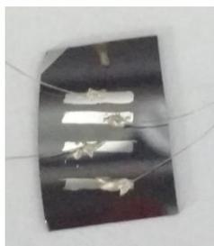
**Figura 17:** Fotografia da amostra com contatos paralelos de alumínio.
