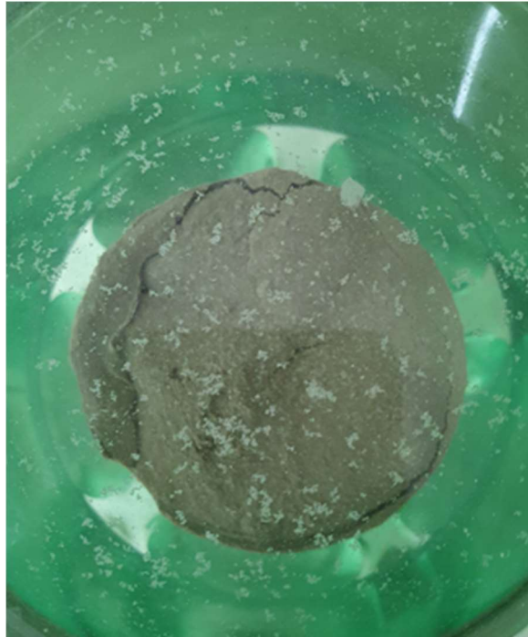
Figura 38 - Resíduos de efluorescência da argamassa ACIII cinza, após processo de evaporação da etapa de imersão do corpo de prova.
