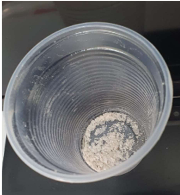
Figura 38 - Resíduos de efluorescência da argamassa ACIII cinza, após processo de evaporação da etapa de imersão do corpo de prova.
