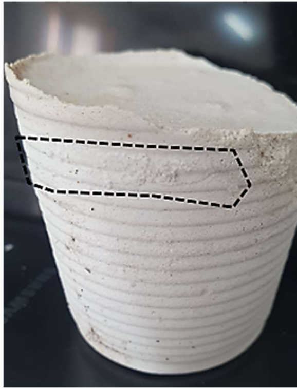
Figura 27 - Corpo de prova argamassa colante ACIII branca
