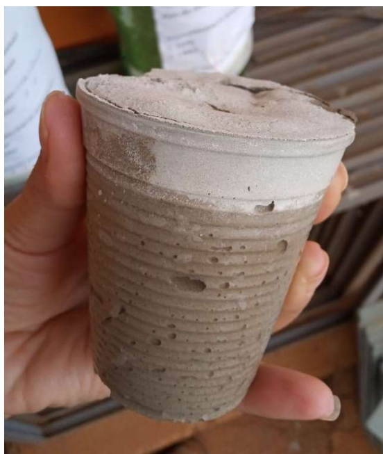
Figura 26 - Corpo de prova argamassa colante ACIII cinza
