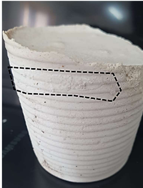
Figura 36 - Corpo de prova ACIII branca Votomassa com pontos de eflorescência.
