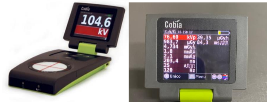
Figura 6 - Cobia Meter e suas medidas.
