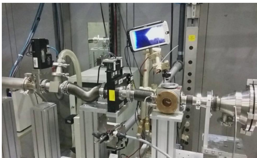
Figura 14 - Foto do sistema de monitoramento em tempo real para avaliar a nanoestrutura das matrizes estudadas durante os ensaios de intumescimento feitos in situ com a técnica de SAXS.
