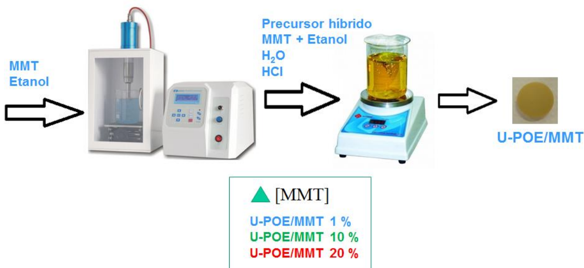
Figura 13 - Representação esquemática das principais reações de policondensação para a obtenção do nanocompósito U-POE/MMT.
