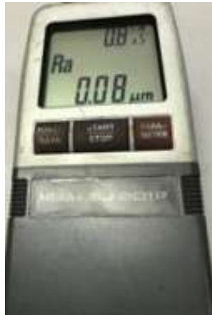
Figura 14: Rugosidade média das amostras exposta no rugosímetro
