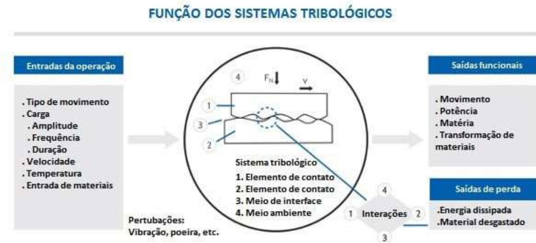
Figura 1: Características gerais de um sistema tribológico.
