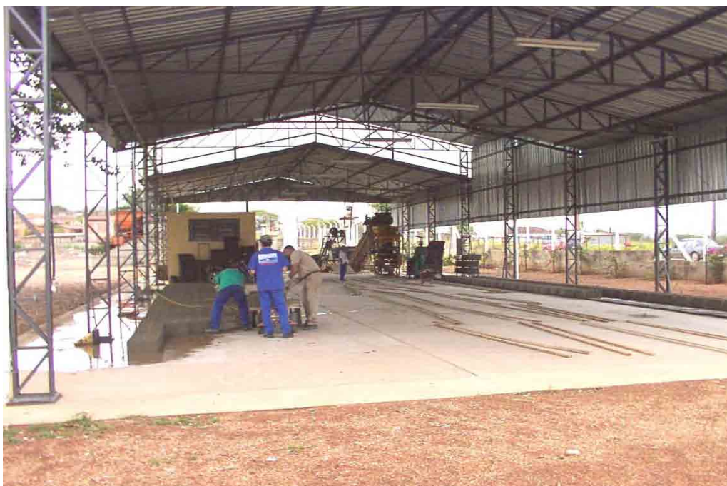
Foto 2.11 (out2003) – Fabrica de blocos de concreto para alvenaria instalada na Usina de Moagem de Piracicaba-SP. Produção diária de 1.400 un.
