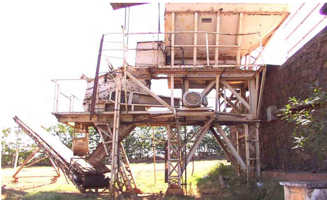
Foto 2.13(ago2003)- Usina de moagem de Ribeirão Preto-SP. Vista do alimentador vibratório e moinho de martelos.
