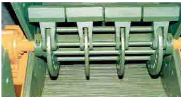
Foto 2.3 Detalhe da ampla câmara de moagem, dos revestimentos laterais e pára-choques.
