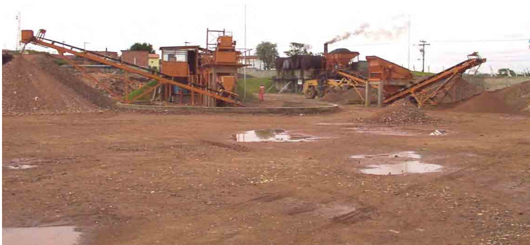
Foto 2.10(out2003)- Usina de moagem de Piracicaba-SP, da esquerda para a direita, pilha pulmão de “bica corrida”, rebritador, transportadores de correias e peneira vibratória. Ao fundo usina de asfalto que utiliza agregados reciclados da usina.
