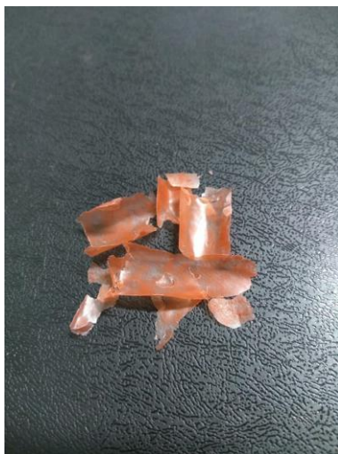
Figura 8. EPS após a secagem em estufa de ventilação forçada a 60°C por 48h, ao final do processo.
