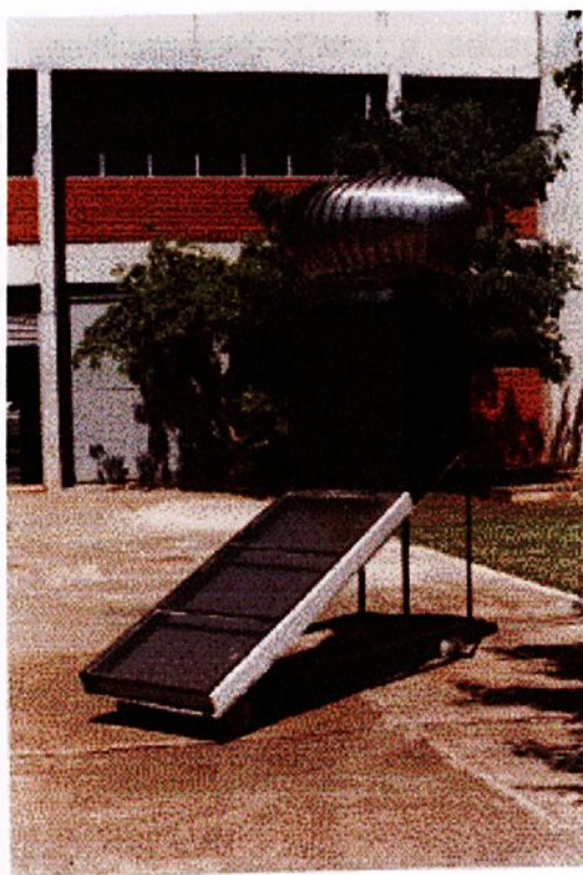
Figura 3.3: Secador acoplado ao coletor solar.
