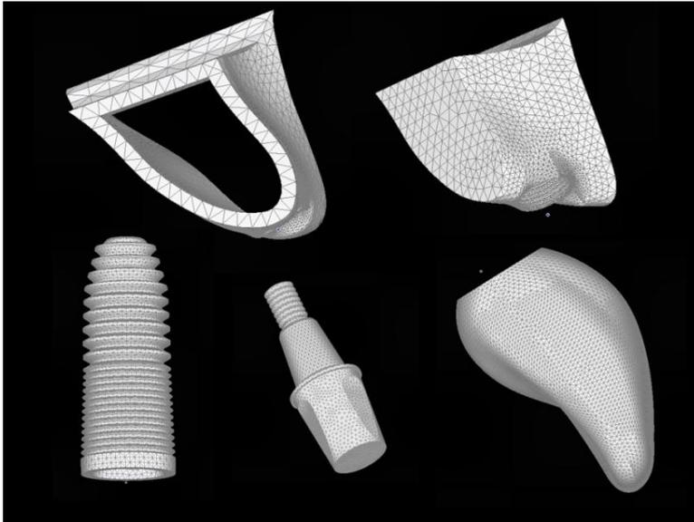
Fig. 3: Malha de elementos finitos.
