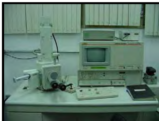
FIGURA 4 – Metalizadora utilizada para aplicação de ouro nos espécimes (Desk II, Denton Vacuum, JEOL Ltda, Tokyo, Japão).
