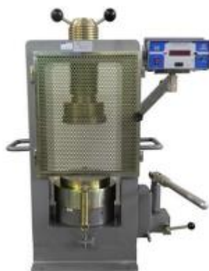
Figura 31 – Prensa de ruptura PAVITEST
